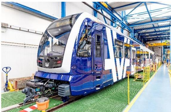
Der erste «Saphir II» Niederflurtriebzug bei der Inbetriebsetzung im Stadler Werk in Bussnang
