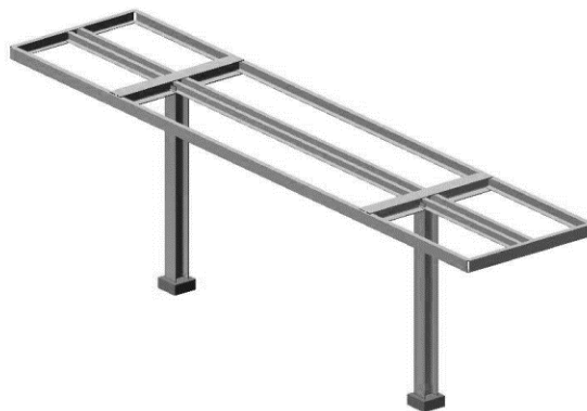
Abbildung 2: Bergfrieden Perrondach (Schöneeggstrasse analog) - Ausschnitt aus dem Statik Modell -
